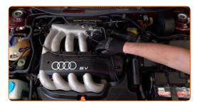
Verifique o nível de óleo 5 minutos após a paragem do funcionamento do motor usando uma vareta e adicione óleo se necessário.
