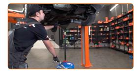
Limpe a área do orifício de drenagem do cárter.
