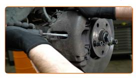
Limpe os fixadores do suporte da pinça de travão. Use uma escova metálica. Use spray WD-40.
