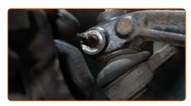
Desaperte o parafuso de fixação do terminal de direção. Use uma chave combinada nº 13.
