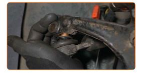
Instale o parafuso de fixação.
