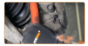
Desaperte a fixação da braçadeira da pinça. Use uma chave soquete nº 17. Use uma chave de catraca. Use uma chave de tarraxa.
