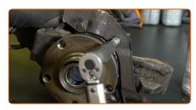
Trate o assento de montagem da coluna de suspensão na manga de eixo. Use uma escova metálica. Use spray WD-40.
