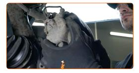
Remova o parafuso de fixação. Use uma chave soquete nº 27.
