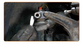
Desconecte o terminal de direção da manga de eixo.
