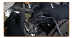
72 Trate do conector do sensor de ABS. Use graxa dielétrica.
