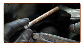
Limpe os fixadores do braço de controlo. Use uma escova metálica. Use spray WD-40.
