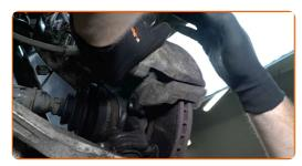
Aperte a braçadeira da pinça do travão. Use uma chave soquete nº 17. Use uma chave de torque. Aperte-o para o torque de 130 Nm.
