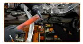
Instale a manga de eixo com um cubo na montagem.
