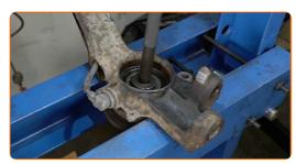
Limpe o local de montagem do rolamento de cubo. Use uma escova metálica. Use spray WD-40.
