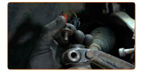
Afaste as orelhas para o parafuso de aperto na extremidade da barra de direção. Use um cinzel plano para metal.
