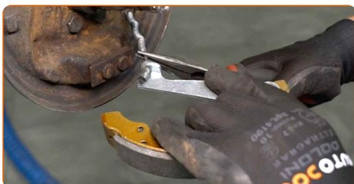
**21** Instale a alavanca de ajuste da sapata de travão.
