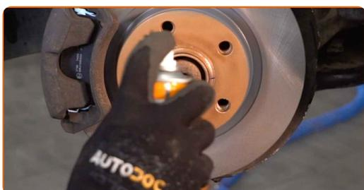
**31** Limpe a superfície do disco de travão. Utilize um produto de limpeza para travões.
