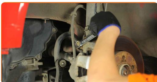
**12** Remova o parafuso de fixação.
