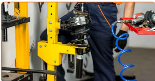
**29** Retire a coluna de suspensão montada.
