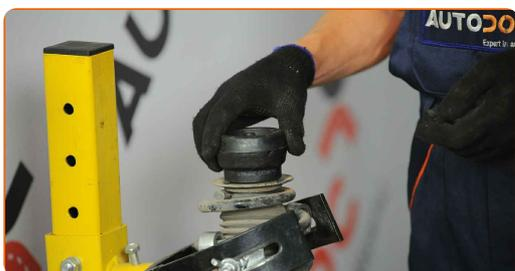
**27** Aperte a porca do suporte do amortecedor da haste do pistão. Use uma chave soquete nº 20. Use uma chave de torque. Aperte-o para o torque de 60 Nm.
