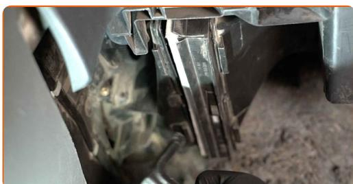
**5** Remova o elemento de filtro a partir da caixa do filtro
