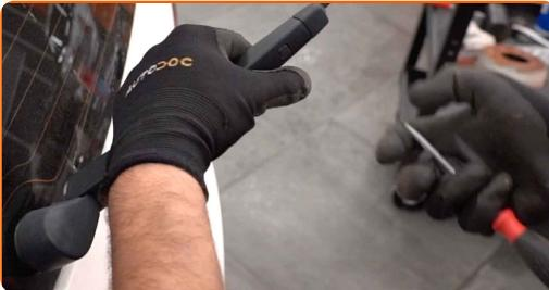
**5** Pressione o clipe de fixação. Use uma chave de fenda plana. Remova a escova do braço do limpa para-brisas.
