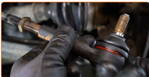
Substituição: terminal de direção – AUDI A3 Hatchback (8L1). Conselho da AUTODOC:
