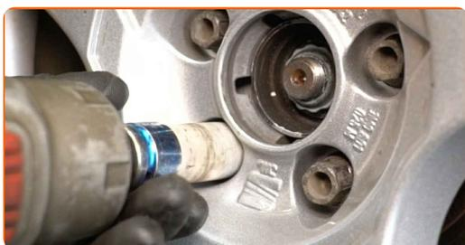
**24** Baixar o carro e trabalhar em ordem transversal, apertar os parafusos das rodas. Use o soquete de impacto para roda #17. Use uma chave de torque. Aperte-o para o torque de 120 Nm.
