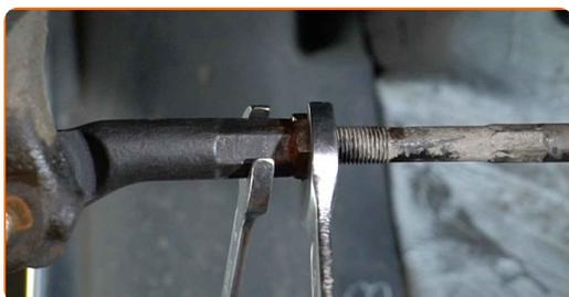
**16** Aparafuse a porca de fixação que liga o terminal de direção à manga do eixo. Use uma chave soquete nº 19. Use uma chave de catraca.
