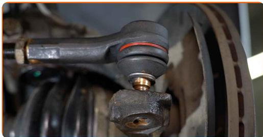
**15** Ponha o terminal da barra de direção na posição correta e fixe-o com a porca de travamento. Use um paquímetro. Use uma chave combinada nº 19. Use uma chave combinada nº 22.
