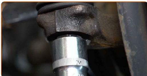
**17** Aperte a porca de fixação conectada ao terminal de direção à manga de eixo. Use uma chave soquete nº 19. Use uma chave de torque. Aperte-o para o torque de 45 Nm.
