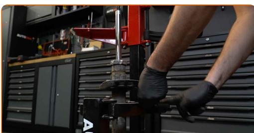
Substituição: kit de suspensão – AUDI A3 Hatchback (8P1). AUTODOC recomenda:
