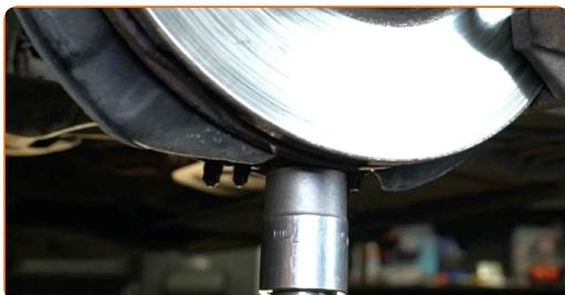
**65** Aperte o parafuso que liga o eixo de transmissão ao cubo de roda. Use a chave de caixa de 12 pontos nº 24. Use uma chave de torque. Aperte-o para o torque de 200 Nm.
