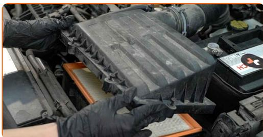
**7** Remova o elemento de filtro a partir da caixa do filtro.
