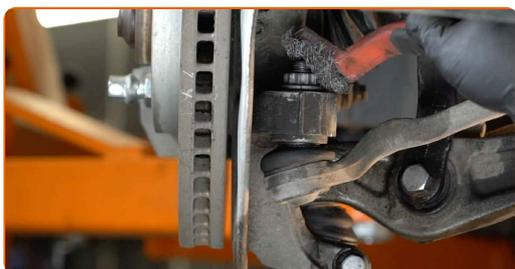
**7** Desenrosque a extremidade da porca de fixação da manga de eixo. Use uma chave combinada nº 21.
