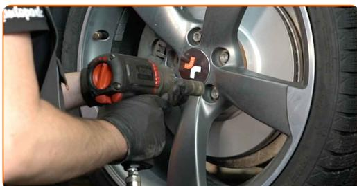
**25** Baixar o carro e trabalhar em ordem transversal, apertar os parafusos das rodas. Use o soquete de impacto para roda #17. Use uma chave de torque. Aperte-o para o torque de 120 Nm.
