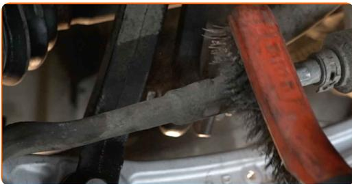
**9** Ao desinstalar, marcar ou medir a posição precisa da articulação esférica na barra de direção, ou contar o número de voltas para evitar posteriormente o desalinhamento. Use um paquímetro.
