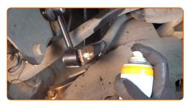
Instale uma nova barra, aperte os parafusos de fixação.
