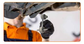
Substituição: tirante da barra estabilizadora – AUDI A4 Avant (8E5, B6). Conselho:
