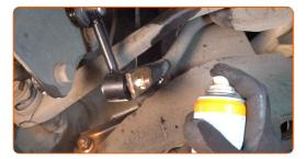
17 Trate a superfície onde o disco de travão entra em contacto com o aro da roda. Use massa de cobre.
