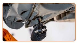
Aperte o fixador que conecta a barra estabilizadora ao braço. Use uma chave soquete nº 13. Use uma chave de torque. Aperte-o para o torque de 25 Nm.
