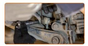
Desaparafuse o fixador que conecta a barra estabilizadora ao braço. Use uma chave soquete nº 13. Use uma chave de catraca.
