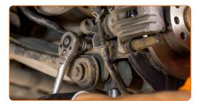
Aperte a fixação inferior do amortecedor. Use uma chave soquete nº 21. Use uma chave de torque. Aperte-o para o torque de 150 Nm.+90°
