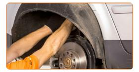
Instale e aperte os elementos de fixação da cobertura do arco da roda. Use Torx T25. Use uma chave de catraca.
