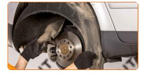
Desaperte a fixação superior do amortecedor. Use HEX n.º H6. Use uma chave de catraca.
