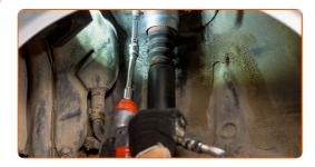
Aparafuse o fixador inferior do amortecedor. Use uma chave combinada nº 21. Use uma chave soquete nº 21. Use uma chave de catraca.
