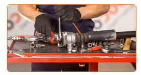
Limpe os locais de montagem do amortecedor. Use uma escova metálica. Use spray WD-40.
