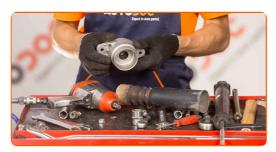
Aperte a fixação superior da haste do amortecedor. Use uma chave combinada nº 17. Use uma chave inglesa. Use uma chave de torque. Aperte-o para o torque de 25 Nm.
