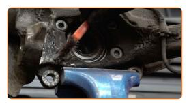
Desaperte a porca do eixo do cubo da roda. Use XZN #12. Use uma chave de catraca.
