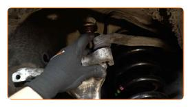
59 Instale o parafuso de fixação.
