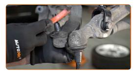
Instale a manga de eixo com um cubo na montagem.
