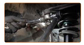
Trate todas as juntas do braço. Trate os fixadores da rótula de suspensão. Trate a porca de fixação conectada ao terminal de direção à manga de eixo. Use massa de cobre.
