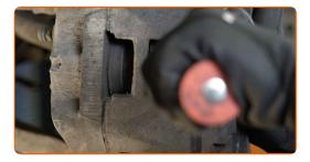
Limpe os fixadores do suporte da pinça de travão. Use uma escova metálica. Use spray WD-40.
