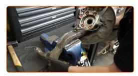
Trate o assento de montagem do cubo de roda. Use uma escova metálica. Use spray WD-40.
