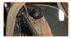
Aperte o fixador da articulação esférica. Use uma chave soquete nº 18. Use uma chave de torque. Aperte-o para o torque de 110 Nm.
