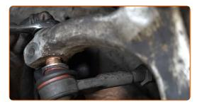
Aparafuse a porca de fixação que liga o terminal de direção à manga do eixo. Use uma chave soquete nº 15. Use uma chave de catraca.
