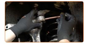
Aparafuse os fixadores da cobertura dos braços de controlo superiores. Use uma chave combinada nº 16 (2 peças).
