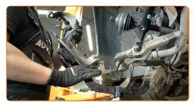
Aperte o cubo de roda juntamente com o rolamento através de um torno.
