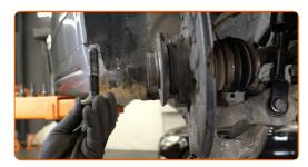
Limpe o elemento fixador do sensor ABS. Utilize a escova de limpeza de nylon. Use o spray de limpeza universal.
