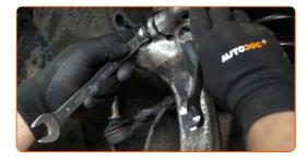
Conecte a extremidade do terminal de direção à manga de eixo.
