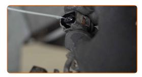
Conecte o sensor do indicador de desgaste das pastilhas de travão.
