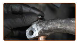
Aparafuse o parafuso de fixação do terminal de direção. Use uma chave combinada nº 13.
