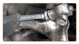
Remova o parafuso de fixação.
