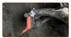
Desaperte o parafuso de fixação do terminal de direção. Use uma chave soquete nº 13. Use uma chave de catraca.
