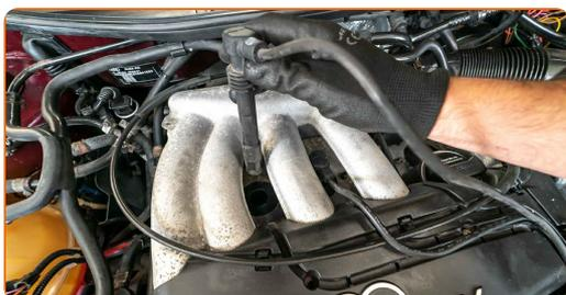
Substituição: vela de ignição – AUDI A4 Avant (8ED, B7). Conselho da AUTODOC:
