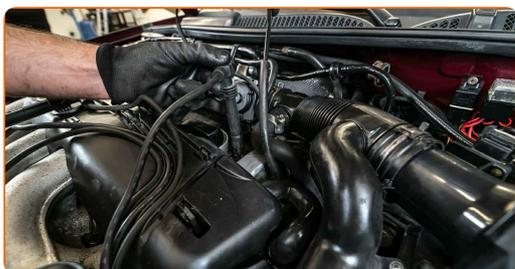
**12** Conecte o conector no coletor de admissão do motor.
