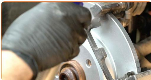
**Substituição: pastilhas de travão – AUDI A4 Avant (8K5, B8). Conselho:**
