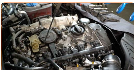
**8** Desaperte as velas de ignição. Use o soquete da vela de ignição #16. Use uma chave de catraca.
