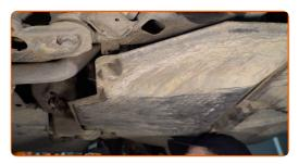
Aperte os parafusos de fixação da tampa de proteção. Use uma chave de fenda plana.
