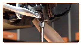
Aperte o fixador traseiro que liga o braço de suspensão à subestrutura. Use uma chave combinada nº 18. Use uma chave soquete nº 18. Use uma chave de torque. Aperte-o para o torque de 70 Nm.+180°
