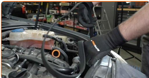
**Substituição: correia trapezoidal estriada – AUDI A4 B7 Avant (8ED).**
