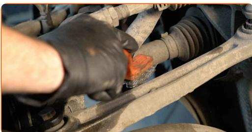
**7** Desaperte a porca de fixação que liga a bieleta da barra estabilizadora à forquilha garfo do amortecedor. Use uma chave combinada nº 16.
