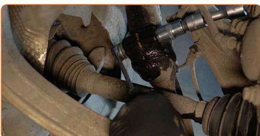
**21** Remova o parafuso de fixação.
