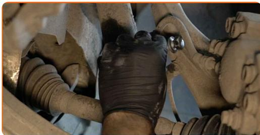
**22** Limpe a fixação do cubo da roda. Use uma escova metálica. Use spray WD-40.
