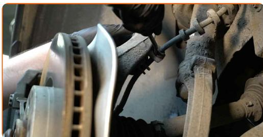
**32** Limpe os elementos de fixação da pinça de travão. Use uma escova metálica. Use spray WD-40.
