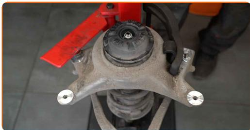
**50** Trate a haste da coluna do amortecedor. Use uma escova metálica. Use spray WD-40.
