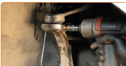
**81** Aparafuse a porca de fixação que liga o terminal de direção à manga do eixo. Use uma chave combinada nº 21.
