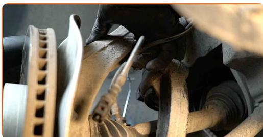
**85** Instale a pinça do travão e fixe-o. Use uma chave soquete n° 13. Use uma chave de torque. Aperte-o para o torque de 30 Nm.
