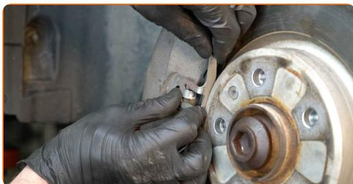
**87** Instale o parafuso de fixação.
