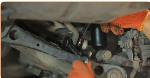
**8** Remova o parafuso de fixação.
