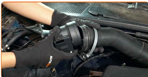
**11** Strângeți elementele de fixare ale senzorului debitmetrului de aer. Use uma chave soquete n° 10. Use uma chave de torque. Aperte-o para o torque de 4 Nm.
