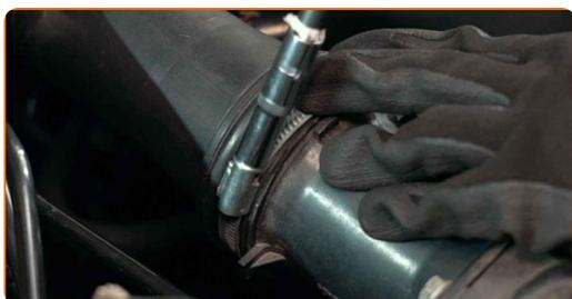
**8** Deșurubați elementele de fixare ale senzorului debitmetrului de aer. Use uma chave soquete nº 10. Use uma chave de catraca.
