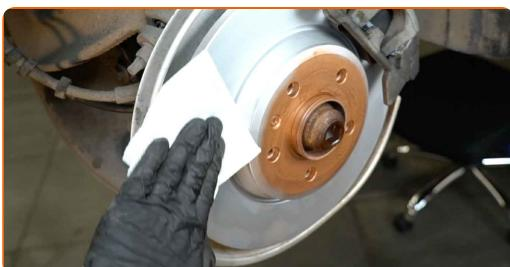
Substituição: discos de travão – AUDI A5 Coupe (8T3). Conselho da AUTODOC:
