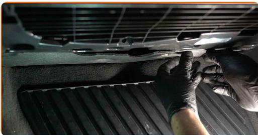
**9** Aparafuse os fixadores do painel de revestimento inferior.
