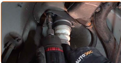
Substituição: amortecedor – AUDI A6 Avant (4G5, 4GD, C7). AUTODOC recomenda:
