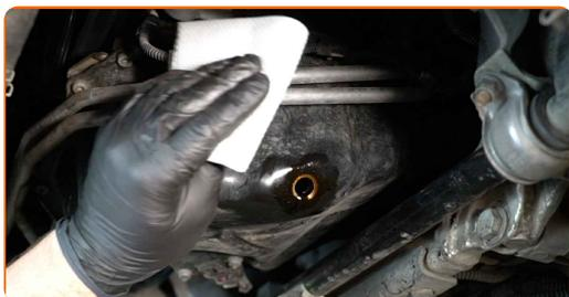
**19** Aparafuse o novo bujão de drenagem e aperte-o. Use Torx T45. Use uma chave de torque. Aperte-o para o torque de 26 Nm.
