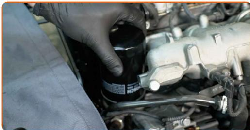
**16** Aparafuse o novo filtro no seu lugar. Use o soquete 76-14F. Use uma chave de torque. Aperte-o para o torque de 18 Nm.
