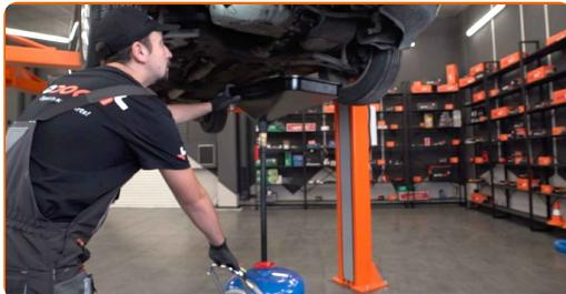
**7** Desaperte o bujão de drenagem. Use uma chave soquete n.º19 ou a chave de anel n.º19.
