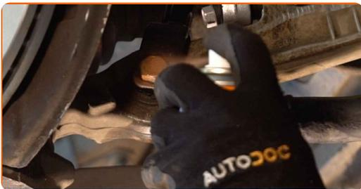
**45** Trate a superfície onde o disco de travão entra em contacto com o aro da roda. Use massa de cobre.
