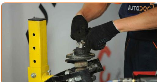
Substituição: cabeçotes do amortecedores – AUDI A8 (4D2, 4D8). AUTODOC recomenda:
