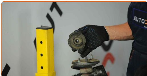
Substituição: cabeçotes do amortecedores – AUDI A8 (4D2, 4D8). Conselho da AUTODOC:
