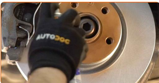
**46** Limpe a superfície do disco de travão. Utilize um produto de limpeza para travões.
