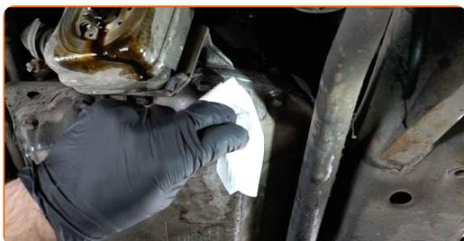
**13** Aparafuse o novo bujão de drenagem de óleo.
