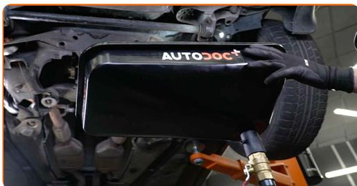
**6** Limpe a área do orifício de drenagem do cárter.
