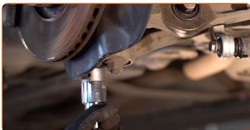
**13** Aperte o fixador que conecta a bieleta da barra estabilizadora à barra estabilizadora. Use uma chave combinada nº 16. Use uma chave soquete nº 16. Use uma chave de torque. Aperte-o para o torque de 40 Nm.+90°
