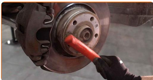
**17** Trate todas as juntas de conexão do estabilizador. Use massa de cobre.
