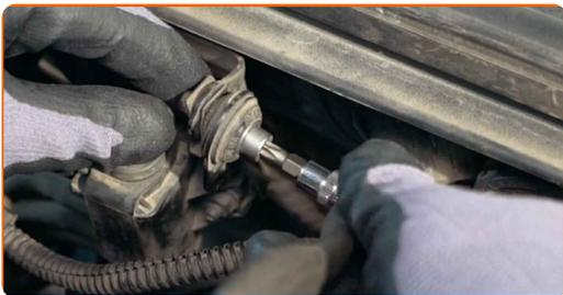
**6** Desaperte a tampa do reservatório de líquido dos travões.
