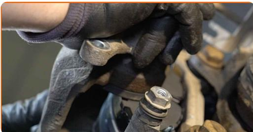
**19** Instale os parafusos de fixação.
