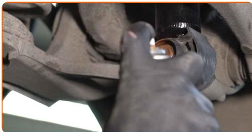
**38** Trate a superfície onde o disco de travão entra em contacto com o aro da roda. Use massa de cobre.
