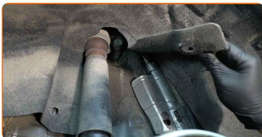
**9** Limpe os elementos de fixação do amortecedor. Use uma escova metálica. Use spray WD-40.
