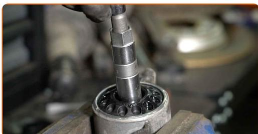
**19** Remova o suporte do amortecedor, a coifa e o batente de encosto do amortecedor.
