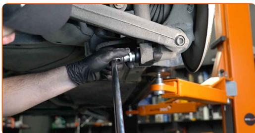
**11** Remova o parafuso de fixação.
