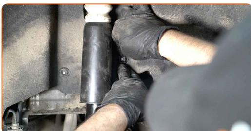
**37** Trate os fixadores do amortecedor. Use massa de cobre.
