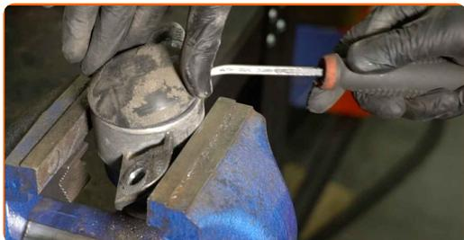
**17** Limpe o elemento de fixação de componentes do amortecedor. Use uma escova metálica. Use spray WD-40.
