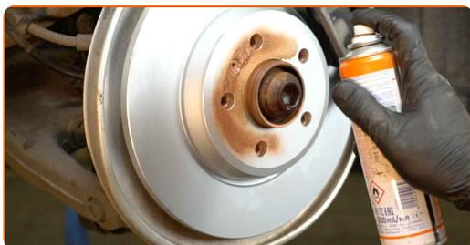
**39** Limpe a superfície do disco de travão. Utilize um produto de limpeza para travões.
