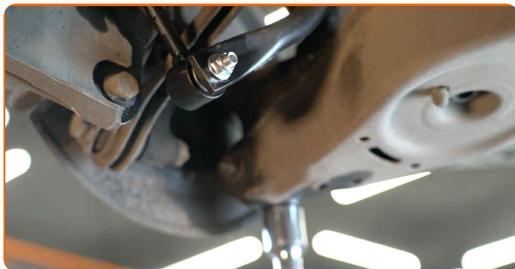
**15** Aperte o fixador que conecta a bieleta da barra estabilizadora à barra estabilizadora. Use uma chave soquete nº 14. Use uma chave de torque. Aperte-o para o torque de 45 Nm.
