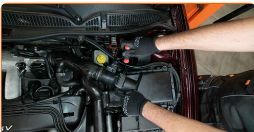
**4** Desconecte o conector do medidor de massa de ar. Solte a braçadeira e remova a mangueira de ar de admissão do alojamento do filtro. Use alicates universais.
