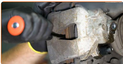
**16** Desaparafuse a fixação de pinça de travão. Use HEX n.º H7. Use uma chave de catraca.
