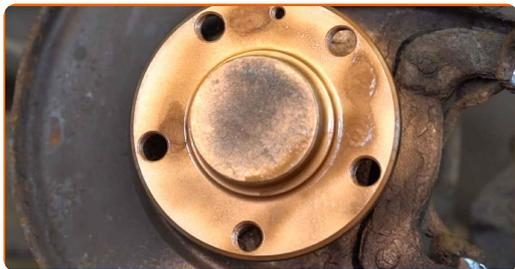
**16** Remova o lubrificante anticorrosivo do novo disco de travão. Utilize um produto de limpeza para travões.
