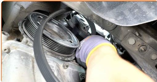
Substituição: correia trapezoidal estriada – AUDI TT Coupe (8N3). AUTODOC recomenda:
