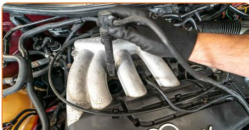
**Substituição: vela de ignição – AUDI TT Coupe (8N3). Conselho da AUTODOC:**
