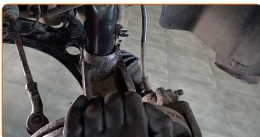
**Substituição: cabeçotes do amortecedores – AUDI TT Coupe (8N3). Conselho da AUTODOC:**
