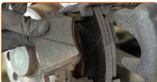
Substituição: pastilhas de travão – AUDI TT Coupe (FV3, FVP). Conselho da AUTODOC:
