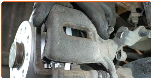
**18** Instale os parafusos de fixação.
