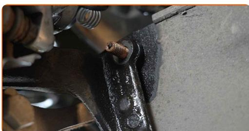
**12** Aperte o fixador da bieleta da barra estabilizadora. Use uma chave combinada nº 14. Use HEX n.º H5. Use uma chave de catraca.
