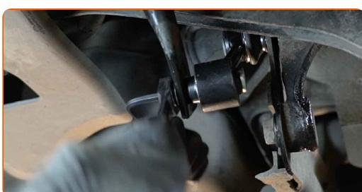
**13** Aperte o fixador que conecta a barra estabilizadora ao braço. Use uma chave soquete nº 14. Use uma chave de torque. Aperte-o para o torque de 45 Nm.
