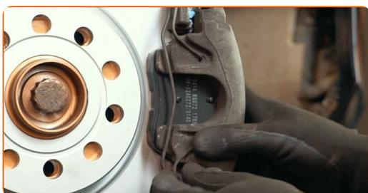
**24** Trate a superfície onde o disco de travão entra em contacto com o aro da roda. Use massa de cobre.
