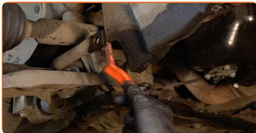
**11** Instale o terminal do estabilizador transversal.
