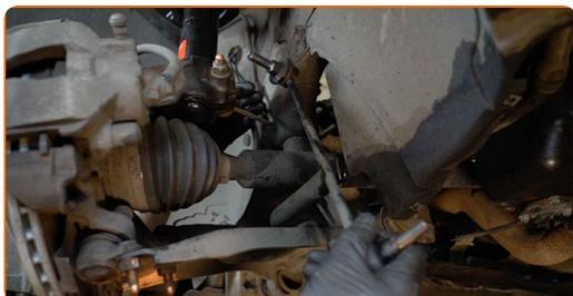
Substituição: tirante da barra estabilizadora – AUDI TT Roadster (FV9, FVR).
