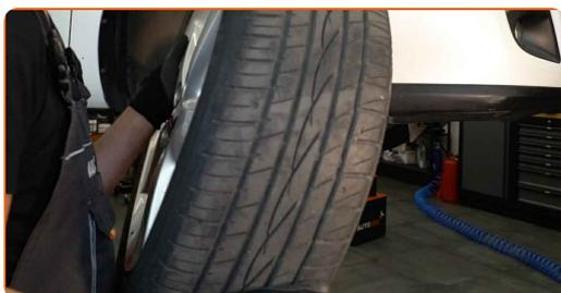
**10** Limpe os elementos de fixação de conexão do estabilizador. Use uma escova metálica. Use spray WD-40.
