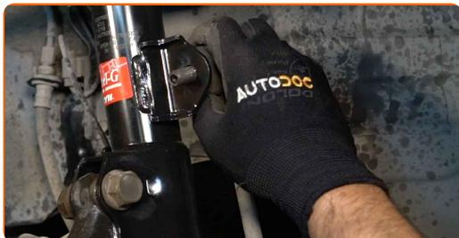
**49** Desaparafuse o fixador que conecta bieleta da barra estabilizadora à barra estabilizadora. Use uma chave soquete nº 17. Use uma chave de torque. Aperte-o para o torque de 74 Nm.
