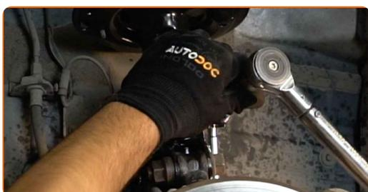
**50** Trate os fixadores do amortecedor. Use massa de cobre.
