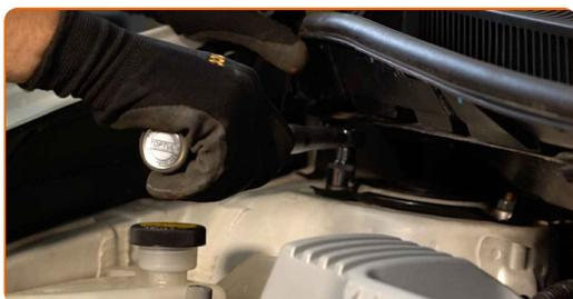
**57** Trate os fixadores do apoio da coluna de suspensão. Use massa de cobre.
