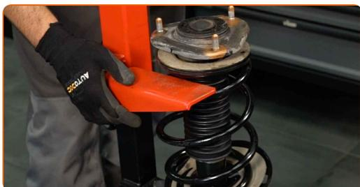
**38** Retire a coluna de suspensão montada.
