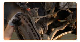
Instale o amortecedor no arco da roda.
