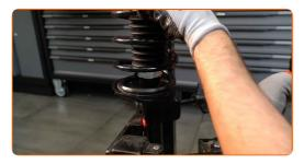
Retire a coluna de suspensão montada.
