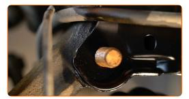
Aparafuse o fixador que conecta o amortecedor à manga de eixo. Use uma chave combinada nº 21. Use uma chave soquete nº 21. Use uma chave de catraca.
