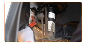
Desaparafuse o fixador que conecta a bieleta da barra estabilizadora à coluna do amortecedor. Use uma chave combinada nº 16.
