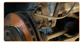
Limpe os fixadores que conectam as colunas de suspensão às mangas de eixo. Use uma escova metálica. Use spray WD-40.
