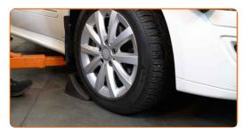
Solte os parafusos de montagem das rodas. Use o soquete de impacto para roda #H12.
