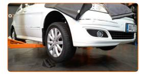
Desaperte os parafusos da roda.
