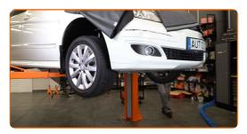
Aperte a fixação superior da montagem do suporte do amortecedor. Use uma chave soquete nº E12. Use uma chave de torque. Aperte-o para o torque de 20 Nm.+45°
