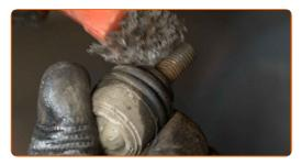
Instale o terminal do estabilizador transversal.
