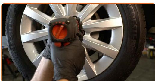
**22** Baixar o carro e trabalhar em ordem transversal, apertar os parafusos das rodas. Use o soquete de impacto para roda #H12. Use uma chave de torque. Aperte-o para o torque de 130 Nm.
