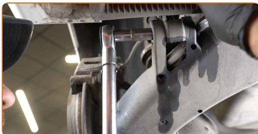
**13** Aperte o fixador que conecta a bieleta da barra estabilizadora à barra estabilizadora. Use uma chave soquete nº 8. Use uma chave de torque. Aperte-o para o torque de 40 Nm.
