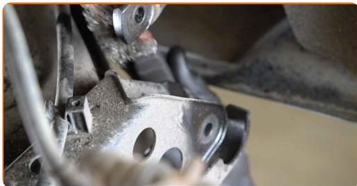
**11** Instale uma nova barra, aperte os parafusos de fixação. Use uma chave combinada nº 16. Use uma chave soquete nº 16. Use uma chave soquete nº 8.
