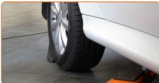
**2** Solte os parafusos de montagem das rodas. Use o soquete de impacto para roda #H12.
