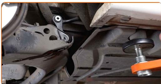
**12** Aperte o fixador que conecta a barra estabilizadora ao braço. Use uma chave combinada nº 16. Use uma chave soquete nº 16. Use uma chave de torque. Aperte-o para o torque de 40 Nm.
